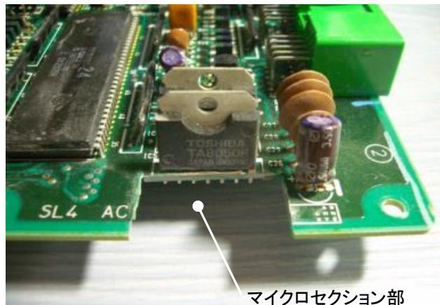
同一形状のパワーIC3ヶのうち1個を切断。一見プローホールに見えるが、恐らくはなんだ付時にガスがA面から逃げられず残留したものと思われる。
